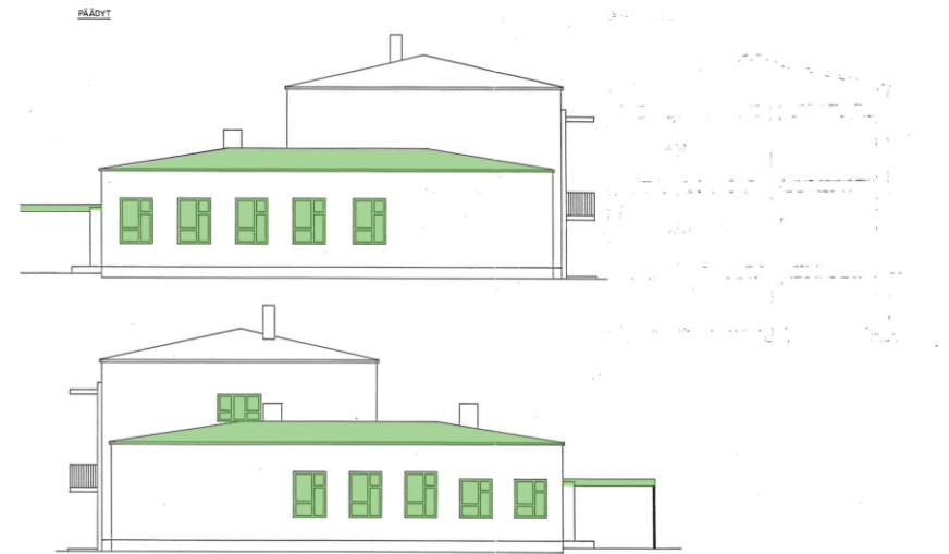
Kuva 39 Julkisivu luoteeseen (ylhäällä) ja kaakkoon (alhaalla). 1980-luvulla tehdyt muutokset korostettu kuviin vihreällä värillä.
